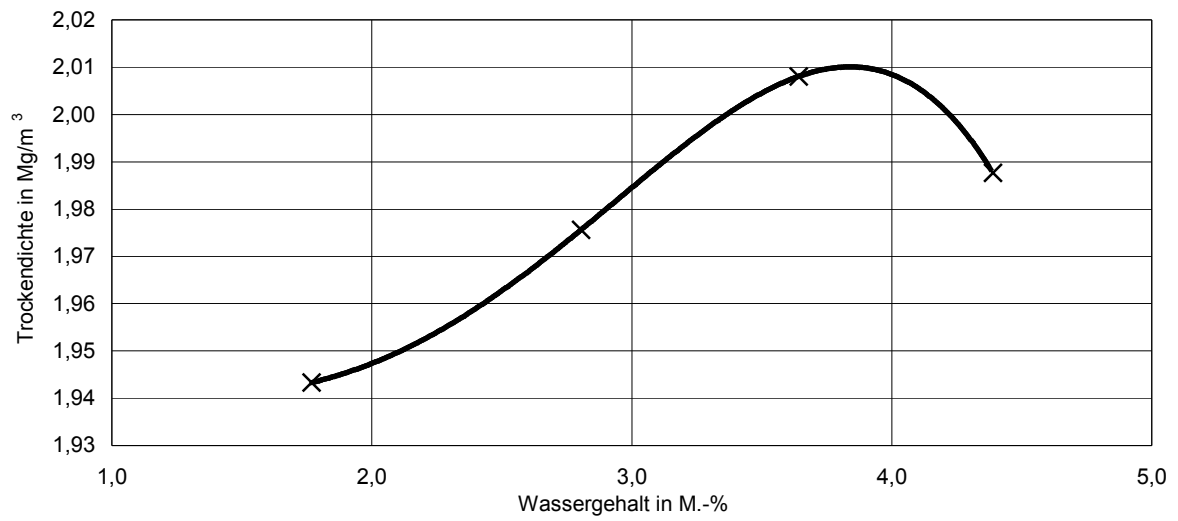
Proctorkurve des Baustoffgemisches 0/32 (STS) gemäß Prüfzeugnis Nr. 42782SoB/21 vom 17.01.2022
