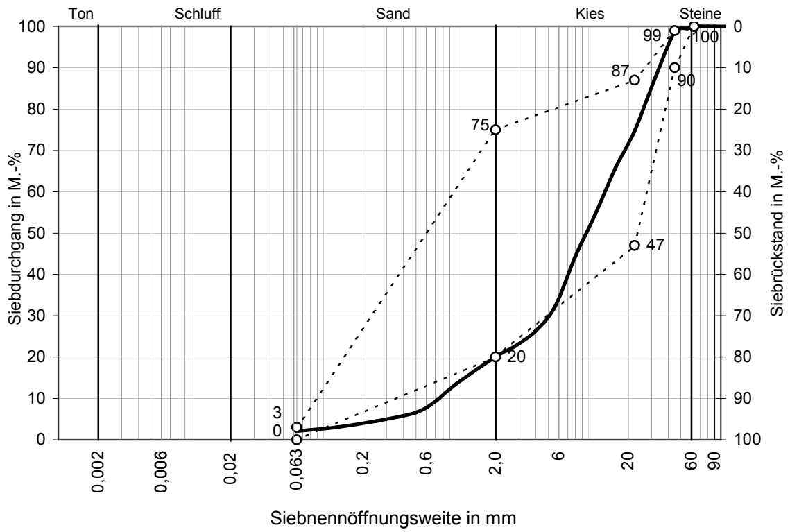
Korngrößenverteilung des Baustoffgemisches 0/45 (FSS - UF 3 )
